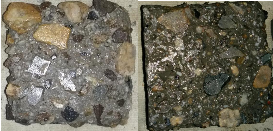
Εικόνα 1: Απώλεια μάζας δοκιμίου C30/37 (αριστερά) και C30/37 με 50% αντικατάσταση της άμμου (δεξιά) μετά από 15 κύκλους ψύξης-απόψυξης
