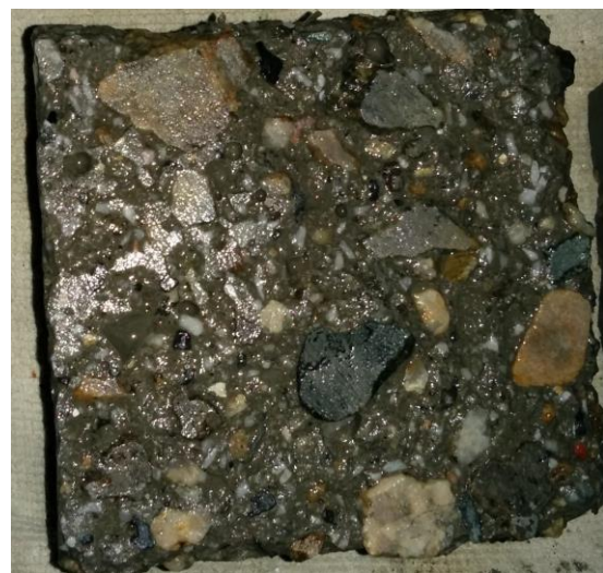
Σχ. 2 Απώλεια μάζας δοκιμίου C30/37 με αδρανή σκωρίας μετά από 15 κύκλους ψύξης-απόψυξης
