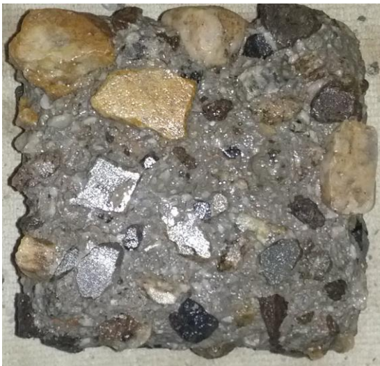
Σχ. 1 Απώλεια μάζας δοκιμίου C30/37 μετά από 15 κύκλους ψύξης-απόψυξης.
