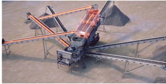
Εικόνα 9: Απεικόνιση Λειτουργίας Δονούμενου Κόσκινου Τριών Καταστρωμάτων
