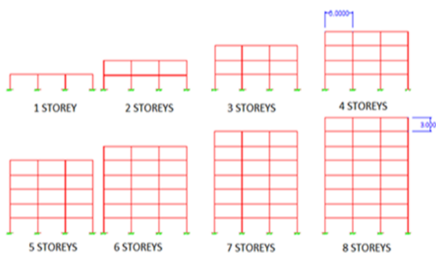
Σχ. 3 Επίπεδα πλαίσια στη διεύθυνση X-X των χωρικών πλαισίων που εξετάστηκαν στην παρούσα εργασία
