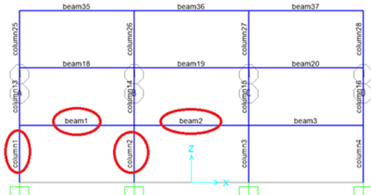
Σχ. 5 Επίπεδο πλαίσιο τριώροφου κτιρίου με σημειωμένα τα δομικά στοιχεία που εξετάστηκαν στα πλαίσια της παρούσα εργασίας για όλα τα κτίρια
