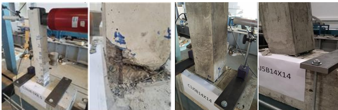
Εικ. 10. Μορφές αστοχίας πειραματικών δοκιμίων
