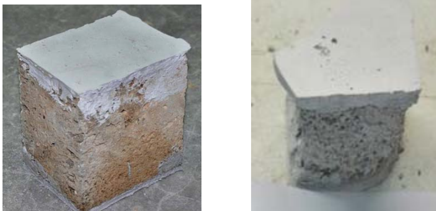
Σχήμα 1. Διαμόρφωση δείγματος λίθου και κονιάματος πριν από τη θραύση τους.
