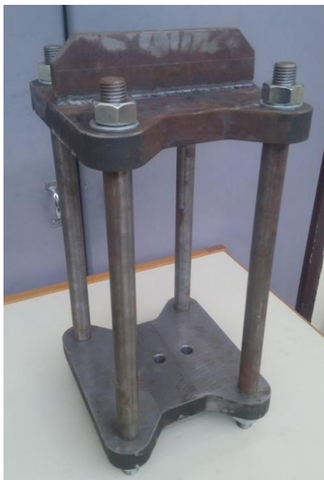
Σχήμα 4. Αριστερά, η ιδιοσυσκευή μεταφοράς δύναμης από τον σιδηροοπλισμό στο σκυροδέμα. Δεξιά, πειραματική διαδικασία μέτρησης της αντοχής συνάφειας μέσω της ιδιοσυσκευής σε σερβοϋδραυλική μηχανή MTS.
