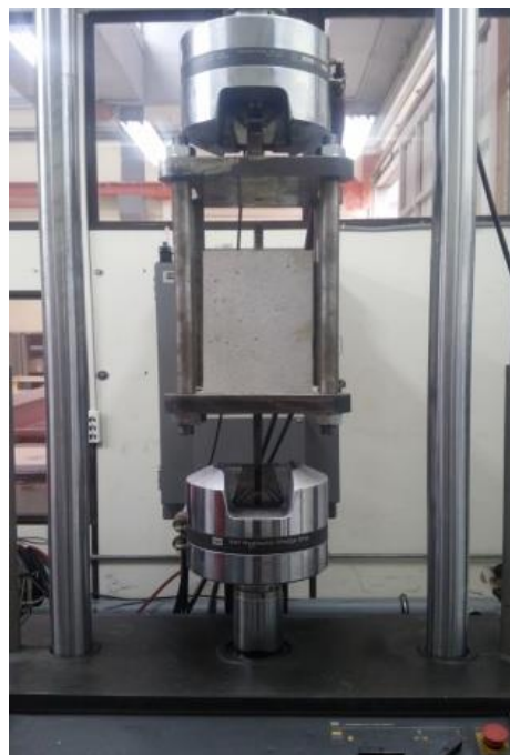
Σχήμα 4. Αριστερά, η ιδιοσυσκευή μεταφοράς δύναμης από τον σιδηροοπλισμό στο σκυροδέμα. Δεξιά, πειραματική διαδικασία μέτρησης της αντοχής συνάφειας μέσω της ιδιοσυσκευής σε σερβοϋδραυλική μηχανή MTS.
