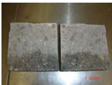
Σχήμα 3: Οπτικός έλεγχος του βάθους διείσδυσης νερού στα σπασμένα δοκίμια
