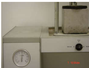
Σχήμα 1: Τοποθέτηση των δοκιμίων στη συσκευή ελέγχου διείσδυσης νερού υπό πίεση
