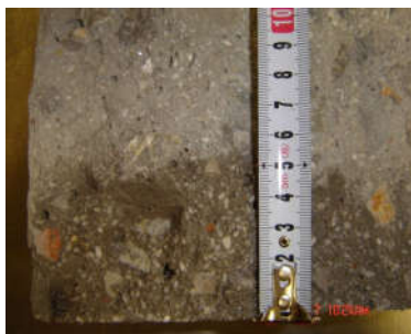
Σχήμα 4: Ακριβής προσδιορισμός του βάθους διείσδυσης νερού
