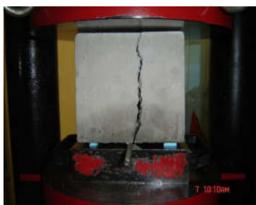
Σχήμα 2: Σπάσιμο των δοκιμίων στη μέση στη συσκευή αντοχής σε θλίψη
