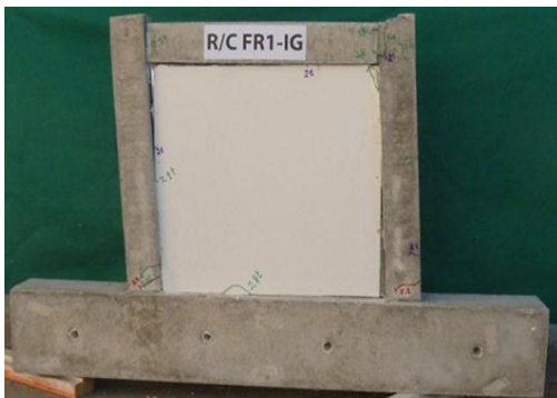
Εικ. 5. Πλαίσιο με γυψοσανίδα (FR1-IG)
