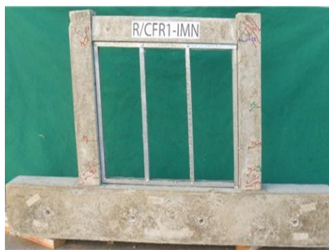
Εικ. 6. Πλαίσιο μόνο με το μεταλλικό σκελετό της γυψοσανίδας (FR1-IMN)
