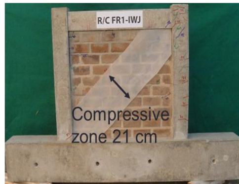
Εικ. 4. Πλαίσιο με τοιχοπληρώσεις και συνδέσμους (FR1-IWJ)
