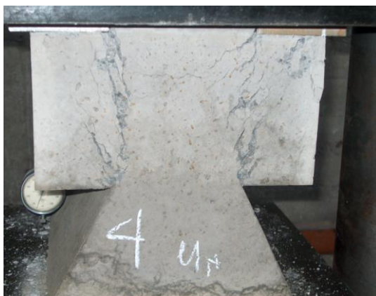
Σχήμα 16. (α) Μορφή αστοχίας Δοκιμίου 1α, (β) Διάγραμμα P-δ για Δοκίμιο 1α.
