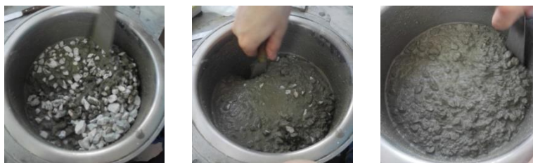
Σχήμα 1. Ανάμειξη χονδρόκοκκων αδρανών για την παραγωγή σκυροδέματος.
