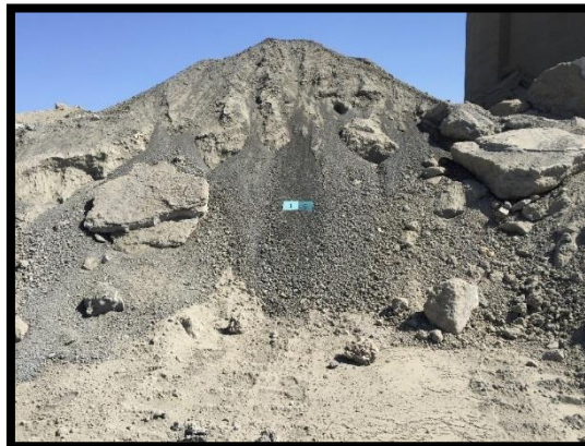
Σχήμα 1. Σωρός υπαίθριου clinker με σχηματισμό συσσωματωμάτων σκληρού clinker.
