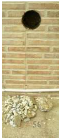
Σχήμα 2. (α) Εκτέλεση πυρηνοληψίας. (β) Καπέλωμα και εύρεση θλιπτικής αντοχής πυρήνων. (γ) Απομείξεις σκυροδέματος και σκυροφωλιές σε Πλ.1'/εσ. Υπ. Κ16
