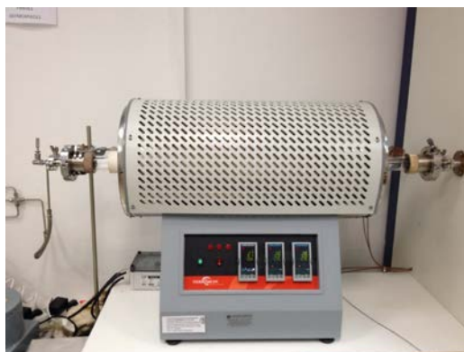
Σχήμα 1. Πειραματική διάταξη που χρησιμοποιήθηκε για τη θερμική χημική εναπόθεση ατμών (TCVD) υδρογονανθράκων προς παραγωγή CNTs
