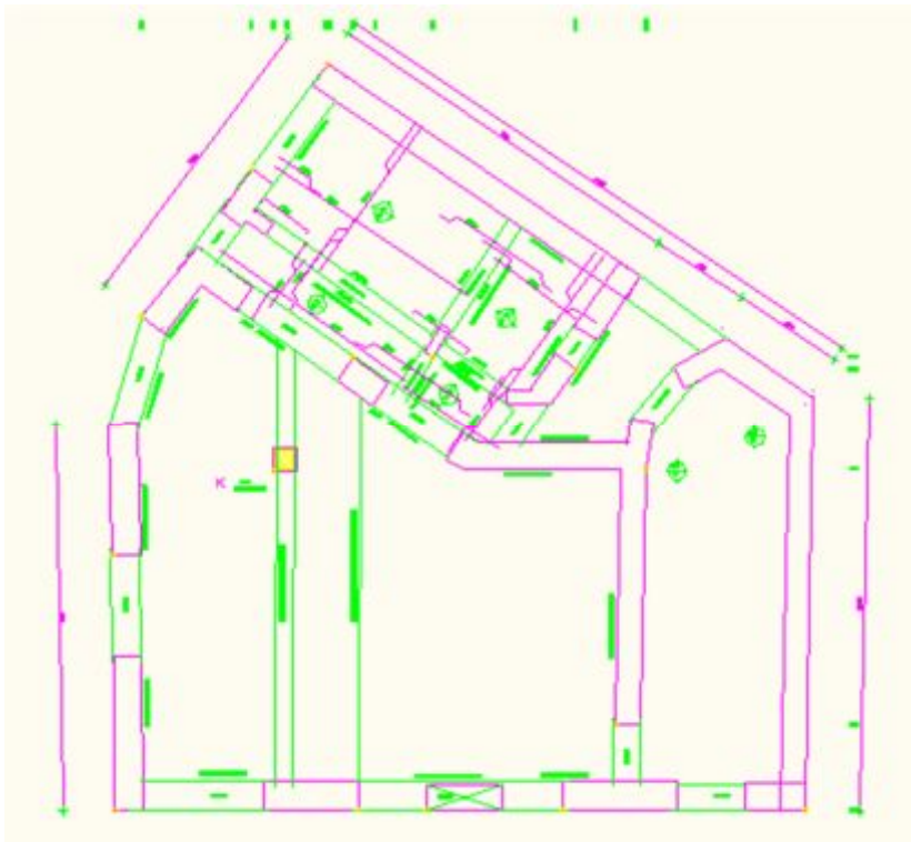
Σχήμα 2: Ξυλότυπος Ισογείου (Αποτύπωση υπάρχοντος)
