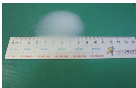
Αδρανή Αερογέλης που χρησιμοποιήθηκαν στα δοκιμαστικά
