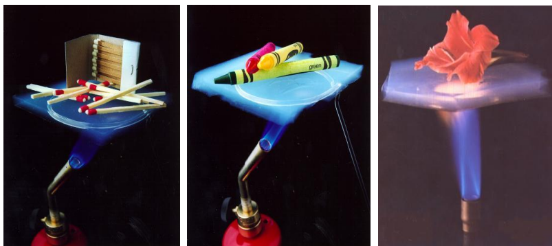
Αντίδραση του Aerogel σε φωτιά Υψηλές Θερμοκρασίες
