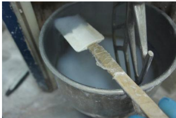
Κονίαμα χωρίς επιφανειοδραστικό- απόμειξη αδρανών αερογέλης και τσιμεντόπαστας
