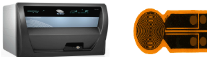
Πειραματική Διάταξη Θερμινόμενου Δίσκου για τη μέτρηση θερμικής αγωγιμότητας στερεών
