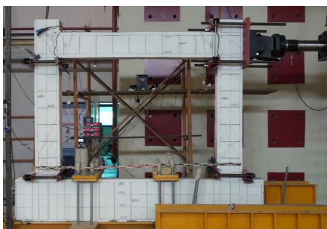
Σχήμα 7. Το ενισχυμένο πλαίσιο μετά την αστοχία των ελκυστήρων.
