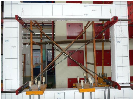
Σχήμα 2. Διαστάσεις και λεπτομέρειες του ενισχυμένου πλαισίου
