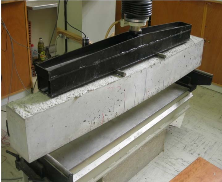
Σχήμα 5. Η δοκός B-G-1 στη δοκιμή κάμψης τεσσάρων σημείων
