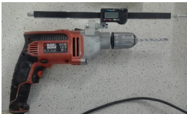
Σχήμα 1. Αριστερά, το δράπανο που χρησιμοποιήθηκε με το μετρητή διείδυσης του τρυπανιού και δεξιά ο μετρητής κατανάλωσης ισχύος
