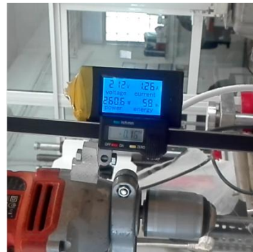
Σχήμα 1. Αριστερά, το δράπανο που χρησιμοποιήθηκε με το μετρητή διείδυσης του τρυπανιού και δεξιά ο μετρητής κατανάλωσης ισχύος
