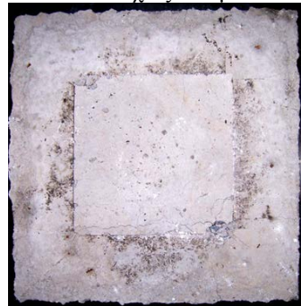
Εικόνα αστοχίας δοκιμίου Δ-6
