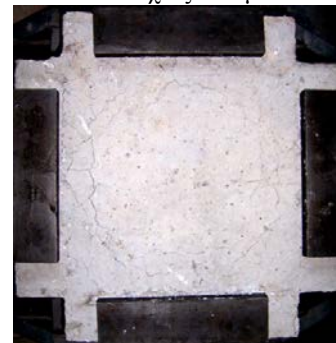
Εικόνα αστοχίας δοκιμίου Δ-8
