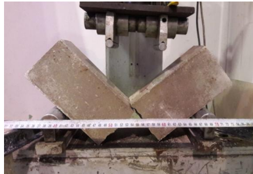
Σχήμα 2. Διαστάσεις, οπλισμός, σύστημα φόρτισης και καμπτική αστοχία δοκών χωρίς οπλισμό
