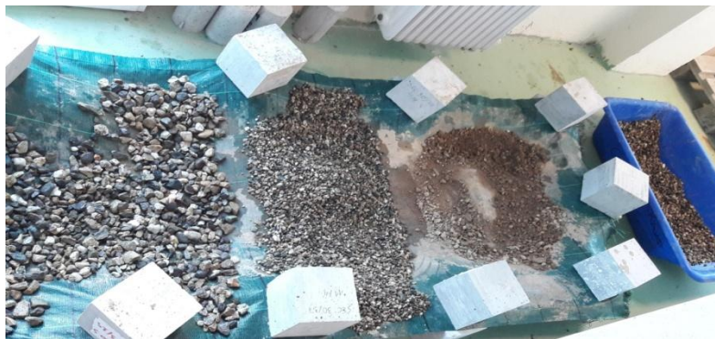
Σχήμα 1. Επιφανειακή ξήρανση όλων των αδρανών
