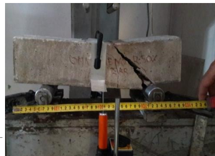
Σχήμα 3. Διαστάσεις, οπλισμός, σύστημα φόρτισης, διατμητική αστοχία (δοκός R50%) και μορφή ρηγμάτωσης οπλισμένων δοκών
