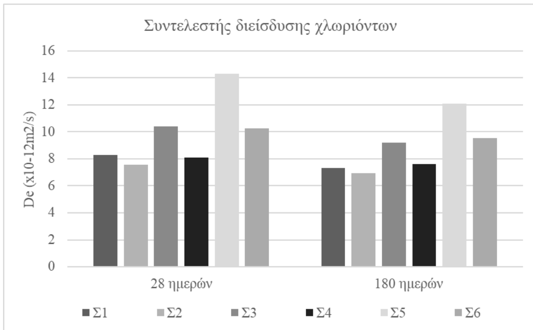
Σχήμα 7. Συντελεστής διείσδυσης χλωριόντων μειγμάτων σκυροδέματος
