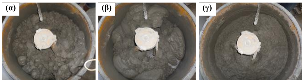
Σχήμα 1. (α-β) Ανάμιξη των λεπτόκοκκων και (γ) τελική κατάσταση (με ίνες).
