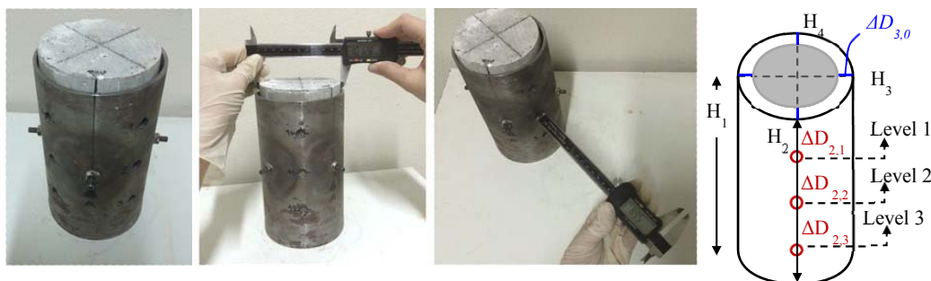
Σχήμα 2. Ιδιοσυσκευή για μέτρηση ογκομετρικής συστολής ξήρανσης και μητροϊκή απεικόνιση των δεικτών μέτρησης.
