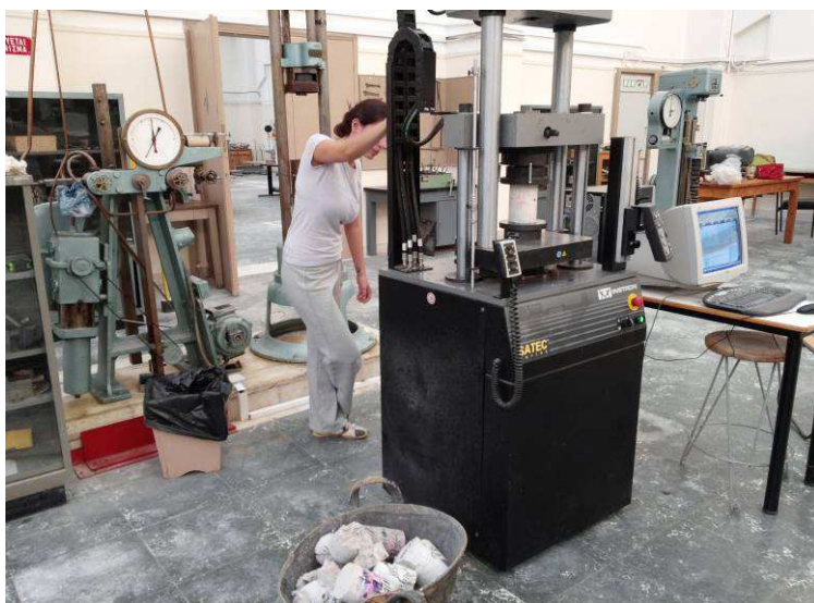
Σχήμα 3: Εργαστηριακός έλεγχος κυλινδρικού δοκιμίου σκυροδέματος που υπόκειται στο πείραμα της ανεμπόδιστης μονοαξονικής θλίψης. Εργαστήριο Αντοχής των Υλικών (ΕΜΠ)
