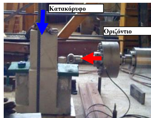
Σχήμα 5. Στήριξη / φόρτιση δοκιμίου
