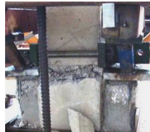
Σχήμα 9. Απόκριση της σύνδεση εμφαννώματος και μανδουωμένου υποστύλωματος με απλή επαφή χωρίς την ύπαρξη χαλύβδινων αγκυριών ή βλήτρων.
