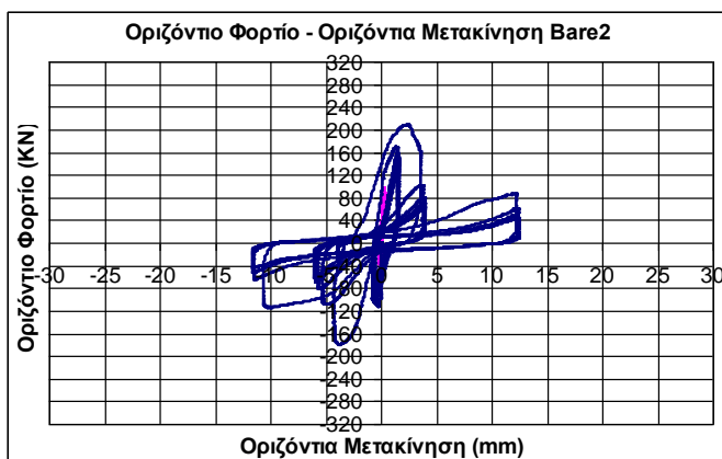
Σχήμα 10. Απόκριση του 1 ου τρόπου σύνδεσης εμφαννώματος και μανδουωμένου υποστύλωματος
