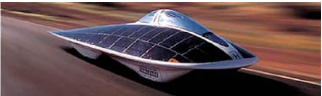
Εικόνα 1: Παράδειγμα ηλιακού αγωνιστικού οχήματος. Η φωτογραφία απεικονίζει το Honda Dream που κέρδισε το World Solar Challenge για δύο συνεχόμενες διοργανώσεις (1993 και 1996) διασχίζοντας με 2 άτομα απόσταση 3.000 km στο εσωτερικό της Αυστραλίας, κινούμενο με μέση ταχύτητα περίπου 90 km/h.
